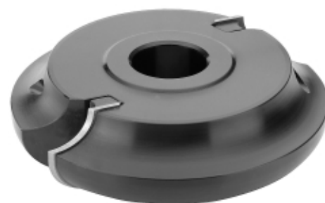
Grundkörper Aluminium Tool body in light alloy Corps de base en alliage léger
